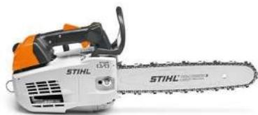
Пила для ухода за деревьями STIHL, с M-Tronic MS 201 TC-M, Шина 30 см - достаточно мощный электроинструмент для ухода за деревьями. Устройство оснащено системой M-Tronic для оптимальной мощности двигателя, экономичным двигателем 2-MIX, "не теряемой" гайкой на крышке цепной звездочки, облегченной шиной для снижения общего веса.
