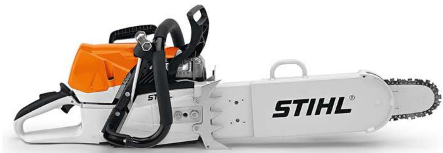
Пила для аварийно-спасательных работ и борьбы с пожарами. Рукоятка на ограничителе реза для быстрой и простой регулировки глубины пиления, фильтр HD2 для отличной фильтрации, система M-Tronic для неизменно оптимальной мощности, большая пусковая рукоятка и декомпрессионный клапан для простого и быстрого запуска двигателя. Специальная пильная цепь с наплавленными твердосплавными пластинами с высокой ударной прочностью.
