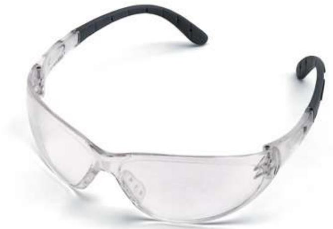
Прозрачные защитные очки. Стекла со специальным внутренним покрытием, предотвращающим запотевание, устойчивым к царапинам наружным покрытием и боковой защитой. Мягкие накладки на концах дужек. 100 % защита от ультрафиолетового излучения. Отвечает требованиям EN 166. Масса 26,0 г.
