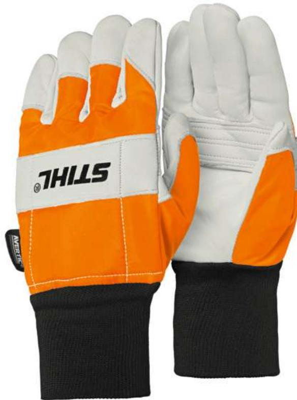
5-пальцевые перчатки, FUNCTION PROTECT MS. Очень комфортные перчатки для работы с бензопилой. Сочетание натуральной кожи и тканей, эластичные трикотажные манжеты, защита от порезов на обеих тыльных сторонах кистей, например, во время ухода за деревьями. Отвечает требованиям EN 381, степень защиты 0 (соответствует 16 м/с).
