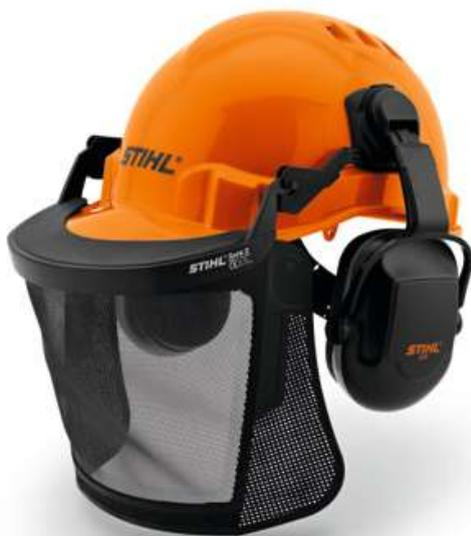
Каска с защитным комплектом и щитком из нейлоновой сетки, с двусторонними вентиляционными отверстиями в верхней части у гребня. С водостоком. Цвет оранжевый. EN 352, EN 397, EN 1731, с наушниками SNR 24 (H:27; M:22; L:15) (106 дБ(А)).
