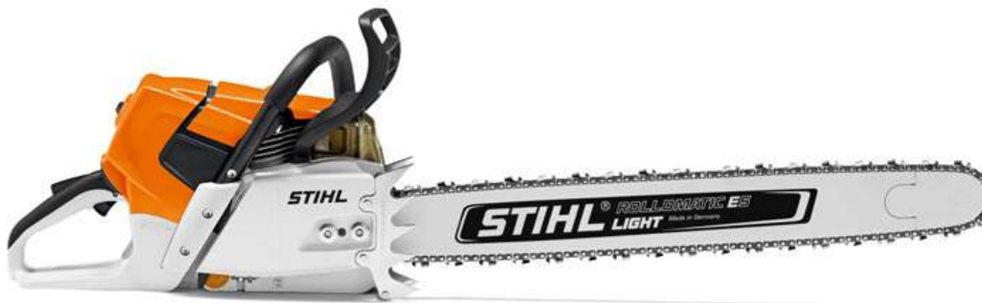
Чрезвычайно мощная высокопроизводительная пила с современной технологией 2-MIX и системой STIHL M-Tronic. Дозирование топлива регулируется электроникой и автоматически адаптируется к изменениям внешних условий. Двигатель бензопилы всегда поддерживает оптимальную мощность. Рассчитана на экстремальную нагрузку. Оптимальный удельный вес. Низкий уровень вибрации. Воздушный фильтр HD2 с радиальным уплотнением. Наша лучшая модель, если речь идёт об эффективной заготовке крупномерной древесины.
