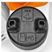
Топливный бак с крышкой, открываемой без дополнительных инструм
