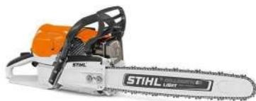
Бензопила MS 462 - современная высокопроизводительная пила для лесного хозяйства. Двигатель 2-MIX позволяет снизить расход топлива на 20%, а вредные выхлопы — на 70% по сравнению с традиционным двухтактным двигателем STIHL. Профессиональная антивибрационная система STIHL для низкого уровня вибрации и оптимального управления. Долговечный воздушный фильтр HD-2. Масляный насос с регулируемой подачей масла. Нетеряемые гайки.
