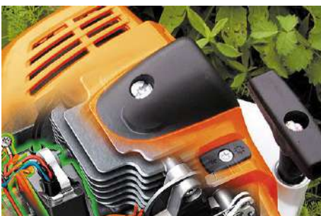
Крыльчатка вентилятора с генератором
